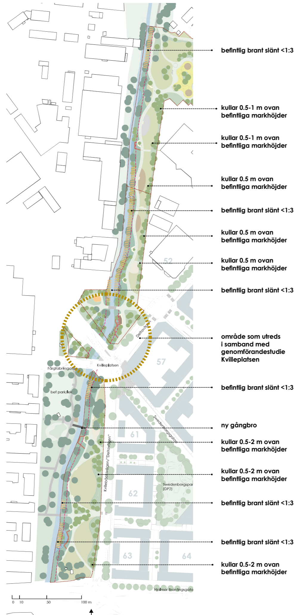
Vid befintliga träd anses trädens rotsystem förhindra erosion och slänt skall ej flackas ut då det är risk att rötter skadas. För att förhindra erosion i vattenlinjen läggs större sten som skydd.
